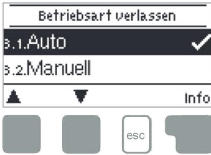
Im Menü "3. Betriebsart" kann der Regler neben dem Automatikbetrieb auch ausgeschaltet oder in einen manuellen Betriebsmodus versetzt werden.
