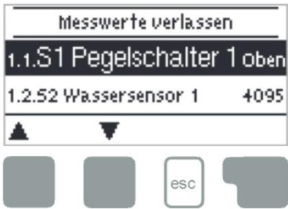
Das Menü "1. Messwerte" dient zur Anzeige der aktuellen Pegelstände, sowie der Wasserdetektoren.
