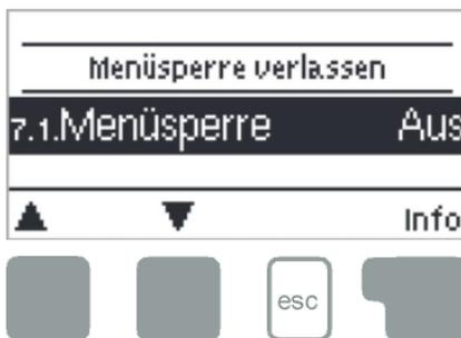
Durch das Menü "7. Menüsperre" kann der Regler dagegen gesichert werden, dass die eingestellten Werte unbeabsichtigt verstellt werden.
