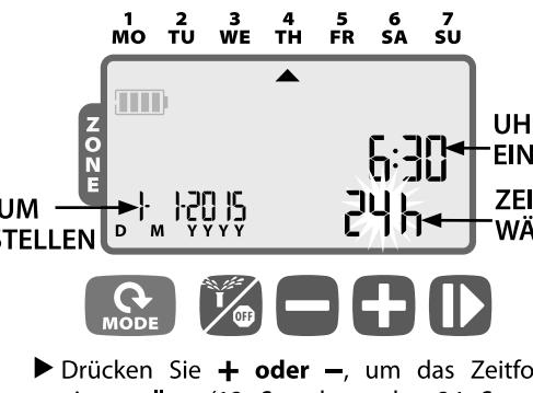
Drücken Sie + oder -, um das Zeitformat einzustellen (12 Stunden oder 24 Stunden); drücken Sie anschließend ►.
